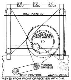
GANG CONDENSER AT MINIMUM CAPACITY POSITION. TONE CONTROL FULLY ANTI CLOCKWISE. WAVECHANGE SWITCH IN SW POSITION.
